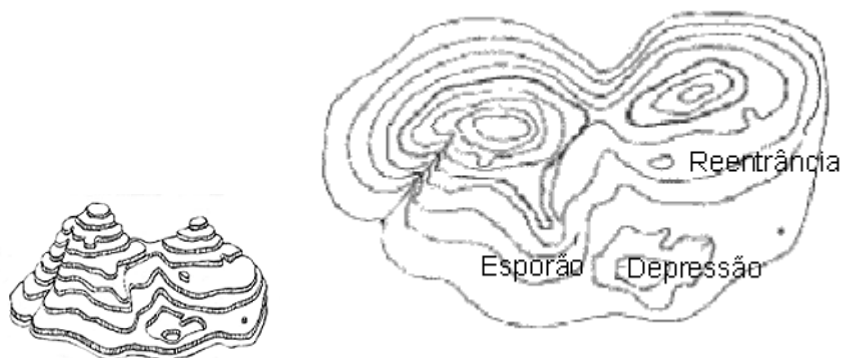
Figura 15 - Iso linhas de altitude ou curvas de nível.
