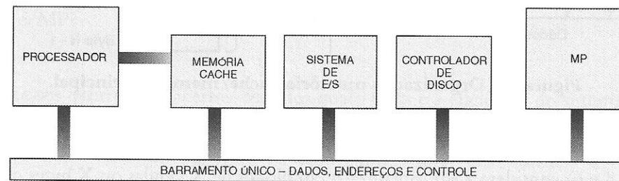
Figura 5.8 Exemplo de um sistema de computação (microcomputador) com utilização de memória cache em um barramento único.
