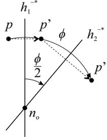
Figura 3.11: Essa figura equivale à Figura 2.16. Ela mostra que uma rotação de  $\phi$  radianos no plano  $n_1 \wedge n_2$  pode ser obtida pela reflexão no hiperplano  $h_1^{-*}$ , seguida pela reflexão no hiperplano  $h_2^{-*}$ , onde  $n_1$  e  $n_2$  são os vetores normais unitários de  $h_1^{-*}$  e  $h_2^{-*}$ , respectivamente. Esses vetores formam um ângulo de  $\phi/2$  radianos.
