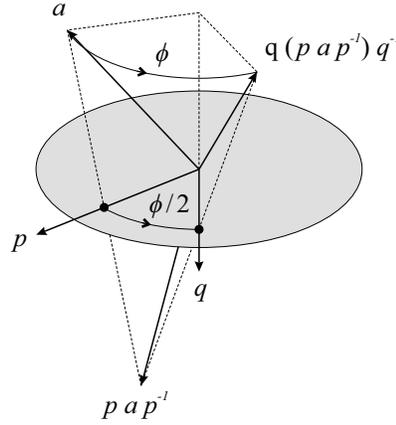
Figura 2.16: Rotação como um par de reflexões. Seja  $a$  um vetor em um espaço Euclidiano. Pela reflexão de  $a$  no vetor  $p$  e, em seguida, em um vetor  $q$ , obtemos o mesmo resultado que pela rotação de  $\phi$  radianos do vetor  $a$  no plano  $p \wedge q$ , onde  $\phi/2$  é o ângulo formado de  $p$  para  $q$ .
