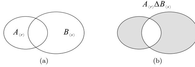
Figura 2.13: Resultado do produto delta, representado por diagramas de Venn. O produto delta de dois blades,  $A_{\langle r \rangle}$  e  $B_{\langle s \rangle}$  (a), produz o blade expandido pelas porções disjuntas, e linearmente independentes, dos blades operados (b).
