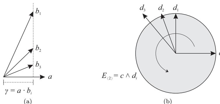
Figura 2.9: O produto interno e o produto externo não são inversíveis. (a) Existe um conjunto infinito de vetores  $b_i$  cujo produto interno  $a \cdot b_i$  resulta no mesmo valor  $\gamma$ . (b) De maneira similar,  $E_{(2)}$  pode ser construído como o produto externo  $c \wedge d_j$  para uma infinidade de vetores  $d_j$  em  $E_{(2)}$ .
