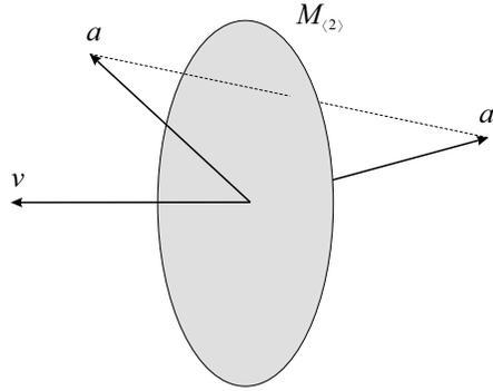
Figura 2.15: Reflexão de um vetor  $a$  em um 2-blade  $M_{(2)}$ , produzindo o vetor  $a'$ . O vetor  $v$  é dual ao blade  $M_{(2)}$ , que age como um espelho. A transformação de  $a$  é aplicada conforme a equação (2.9.84) e em um espaço Euclidiano 3-dimensional.
