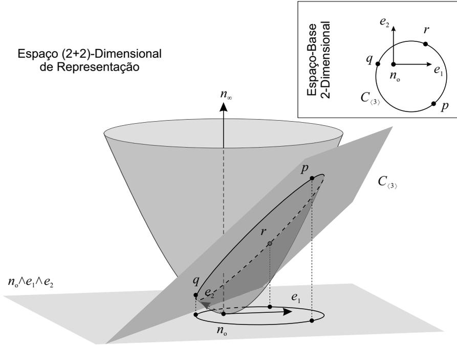
Figura 3.6: No modelo conforme, blades interpretados como círculos ( $C_{(3)} = p \wedge q \wedge r$ ) definem um plano na visualização homogênea do espaço de representação. A elipse resultante da intersecção desse plano com o parabolóide de pontos finitos retorna o conjunto de pontos que, projetados ortograficamente no espaço-base, dão a interpretação geométrica do 3-blade.
