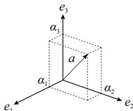
Figura 2.1: Um vetor  $a$  é representado graficamente por um segmento de reta orientado, onde o comprimento do segmento e a seta representam, respectivamente, o módulo e a orientação de  $a$ . Nesse exemplo, os vetores  $\{e_i\}_{i=1}^3$  definem a base do espaço vetorial  $\mathbb{R}^3$  e os valores escalares  $\{\alpha_i\}_{i=1}^3$  permitem descrever algebricamente o vetor  $a$  como a combinação linear dos vetores de base (equação (2.1.1)).
