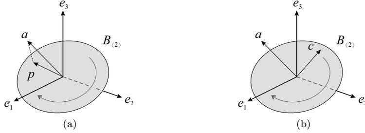
Figura 2.7: Intuição geométrica para o cálculo da contração de  $a$  sobre  $B_{(2)}$  em um espaço Euclidiano  $\mathbb{R}^{3,0}$ . (a) Primeiro, o 1-blade  $a$  é projetado ortogonalmente sobre  $B_{(2)}$ , resultando no vetor  $p$ . Então, os vetores  $a$  e  $p$  são operados sob o produto escalar, resultando no valor escalar  $\gamma$ . (b) Em seguida,  $\gamma$  escala a porção de  $B_{(2)}$  que é ortogonal a  $a$  e a  $p$ , resultando em  $c$ .
