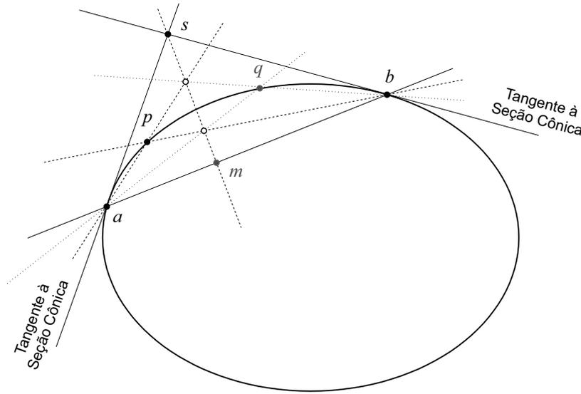
Figura 4.3: Desenho de seções cônicas. A relação geométrica entre os pontos  $a$ ,  $b$ ,  $p$ ,  $s$  e  $m$  é utilizada na obtenção do ponto  $q$  sobre a cônica. Todos os pontos pertencentes à seção cônica podem ser calculados movendo-se o ponto  $m$  sobre a reta definida por  $a$  e  $b$ .
