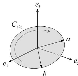
Figura 2.2: Um subespaço 2-dimensional  $C_{(2)}$ , expandido pelos vetores  $a$  e  $b$ , é representado graficamente por um disco. Sua magnitude é representada pelo raio do disco, enquanto que sua orientação é indicada pela seta curva. Nesse exemplo,  $C_{(2)}$  está inserido em um espaço tridimensional, com base  $\{e_i\}_{i=1}^3$ .
