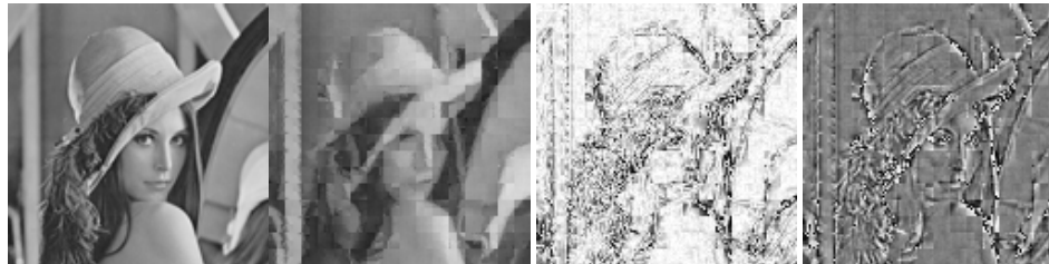
Figura 4.2 Busca Exaustiva Leve com passo \Delta=8 e blocos molde de 4x4 pixels.
