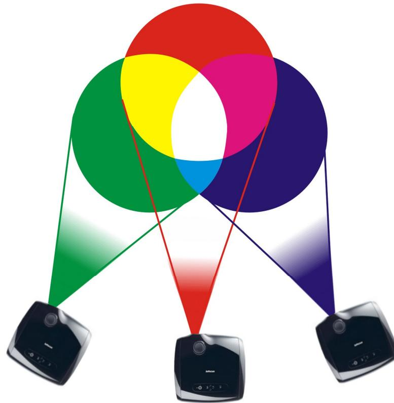
Cores aditiva obtidas pela combinação de luzes RGB
